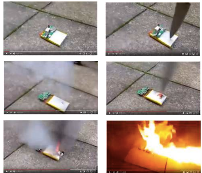
Images 29 - Explosion d'une batterie de téléphone portable
