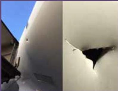
Figure 43 Exemples d'incidents liés aux véhicules et équipements sur pistes et en contact de l'avion
